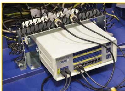
Sistema de Control y Adquisición de Datos ubicado debajo de la cámara de pruebas.
