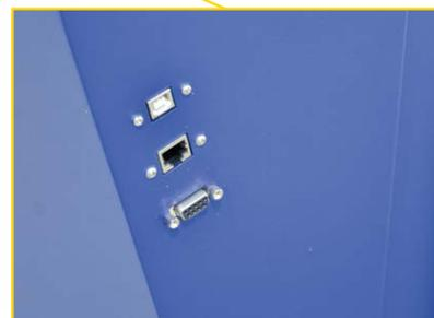
Puertos Ethernet, USB tipo B y serial para la conexión.
