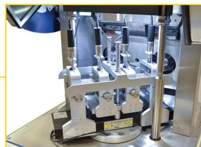
Aparato de flexión en cuatro puntos instalado en la máquina.
